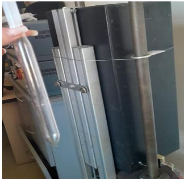
Şəkil. Bricman-Stokbarger metodu ilə sintez prosesi, Fizika İnstitutu
