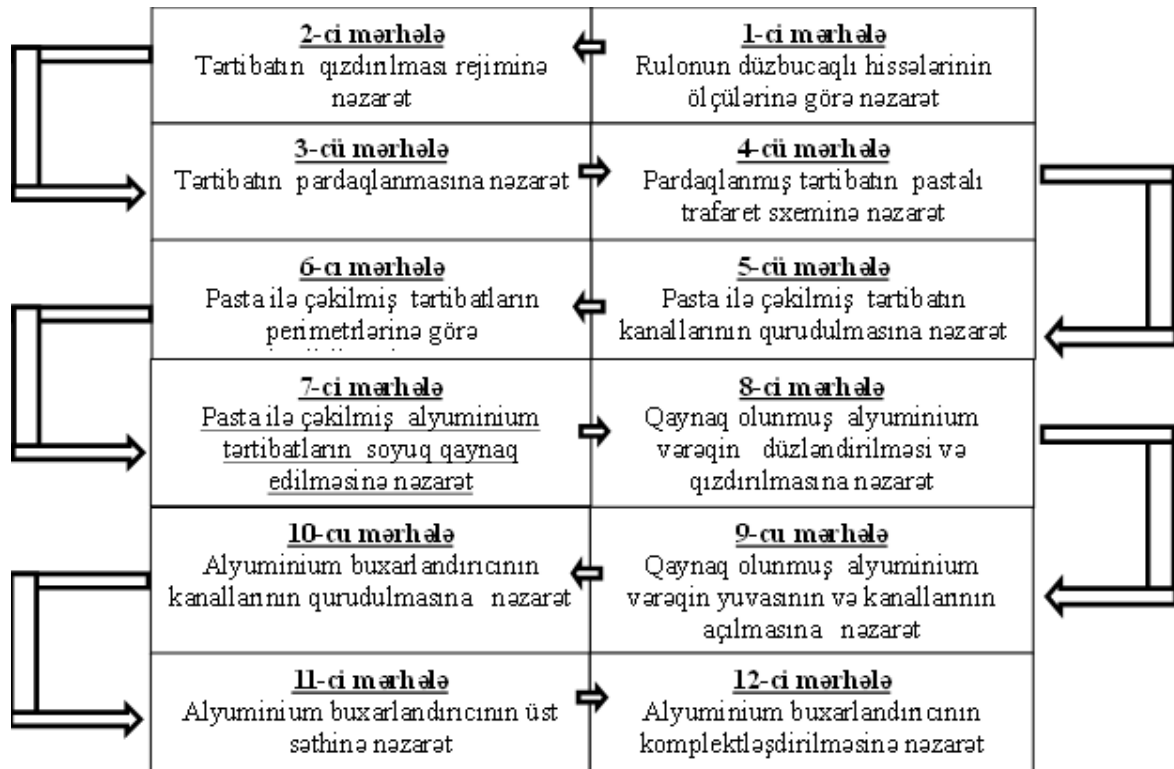
Qrafik. Alüminium buxarlandırıcılarının çevik istehsalat sisteminin istehsal prosesinin kompleks nəzarət sxemi
